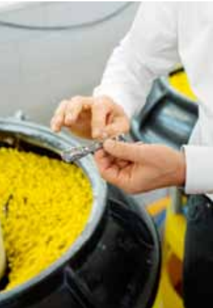
Abrasive Verfahren – das «Abschleifen» von Unebenheiten – und chemische Bäder sorgen für glatte Oberflächen und porentiefe Reinheit.
